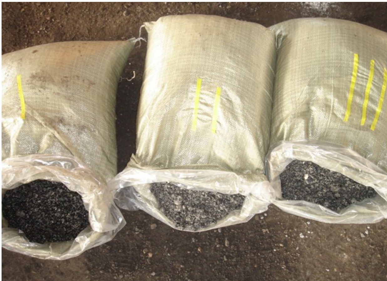
Рисунок 7.7 – Пакетирование холодной ремонтной смеси в пластиковые мешки (Лазовское ДРСУ, п. Переясловка, Хабаровского края)
